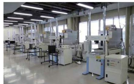
温湿度一定環境下で疲労試験を行う50kN疲労試験機
